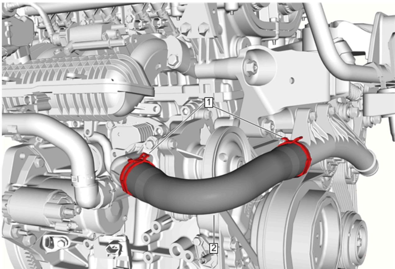
2. 将水泵进水软管连接至水泵进水硬管。
