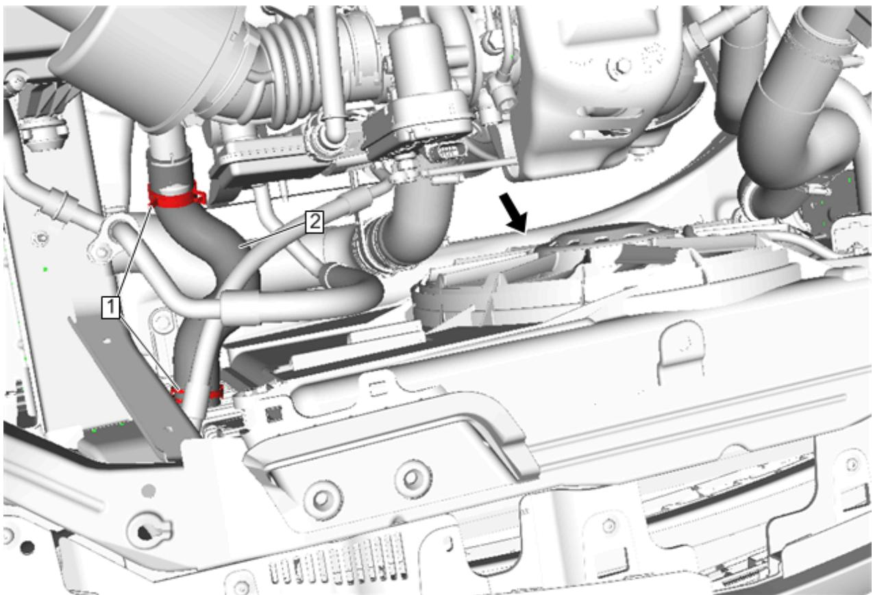
4. 将散热器出口软管(2)连接至水泵进水管。
