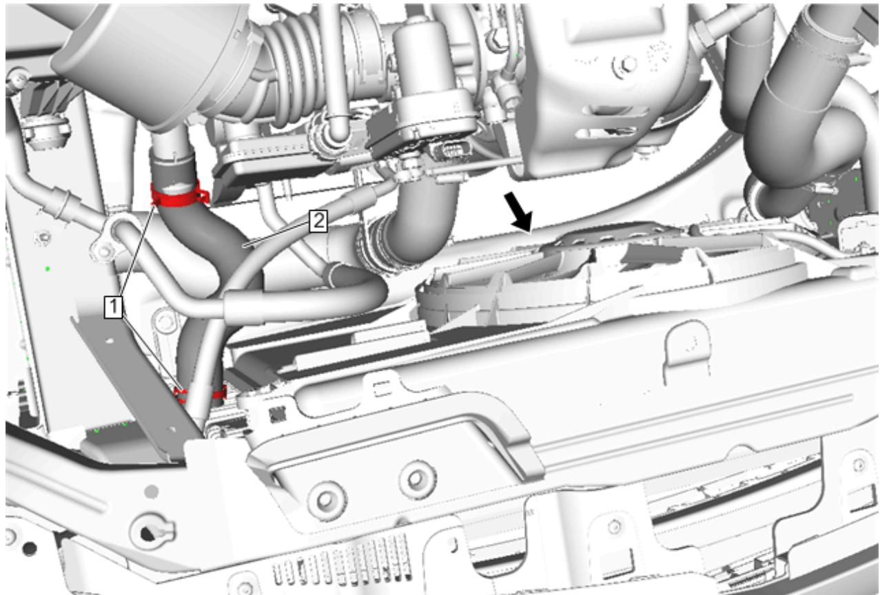
3. 松开散热器出口软管卡箍 (1)。
